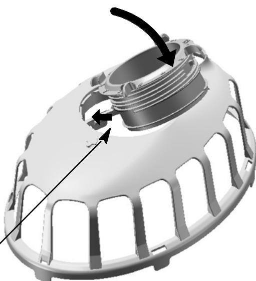
Протолкните нижнюю кромку регулировочного кольца с вращательным движением в винтовую резьбу решетки.
