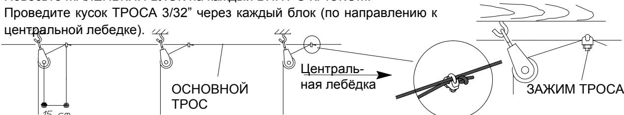
Зафиксируйте этот трос на расстоянии 15 см от блока к основному тросу 3/16" с помощью зажима троса.
